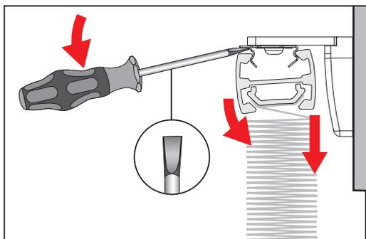
Montage mit Klemmträger (Für 4-25mm geeignet)
